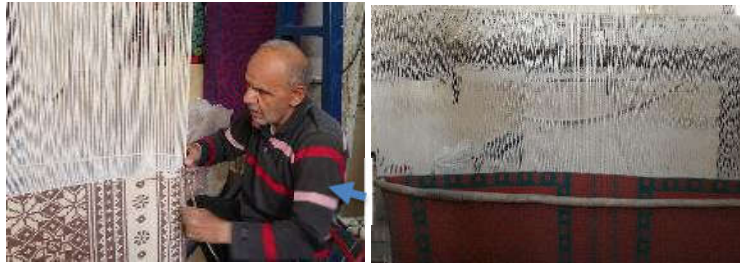
تصویر ۱۷: راست: سوزن نگه‌دارنده و پهنا بند، چپ: آقای صحرائی شاغل در کارگاه زیلوبافی فدوی، مشغول محکم کردن پهنا بند
