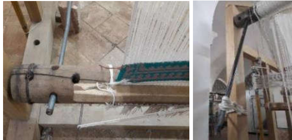
تصویر ۲۵: تنظیم فشار چله‌ها: با استفاده از تنگ‌ها صورت می‌گیرد. تنگ بالا و پایین را مهار می‌کنند.
