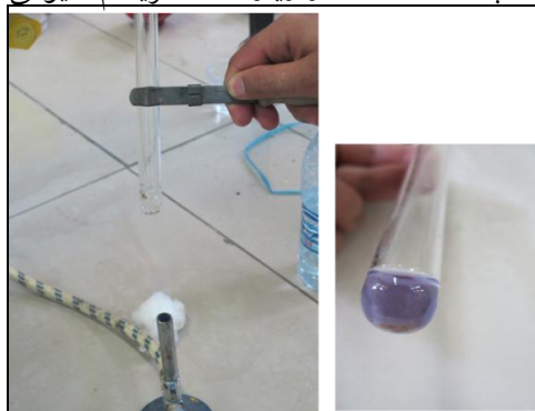
شکل (۱۲): شناسایی چسب سریشم با استفاده از آزمایش نین‌هیدرین (نگارنده)
