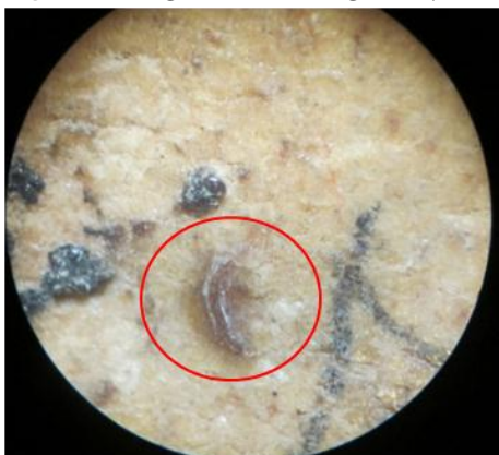
شکل (۲۱): نمایش سریشم خشک شده روی زیارتنامه، بزرگنمایی 40X (نگارنده)
