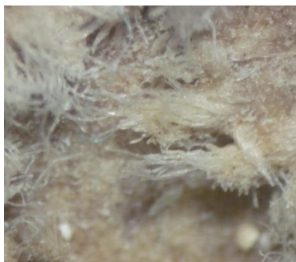
شکل (۱۴): الیاف پارچه زیارتنامه، بزرگ‌نمایی 40X
