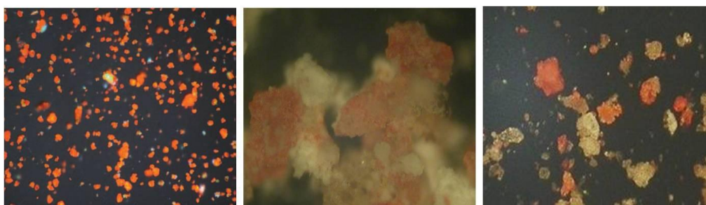
شکل ۱۳: راست: تصویر میکروسکوپی نمونه km1 سرنج و گچ، بزرگ‌نمایی 400X، وسط: تصویر میکروسکوپی نمونه km6 سرنج و گچ، بزرگ‌نمایی X400؛ چپ: تصویر میکروسکوپی سرنج موجود در اطلس رنگدانه برای مقایسه، بزرگ‌نمایی 500 X (Eastaugh, 2008: 728 ff)، همه تصاویر در نور پلاریزه است.
