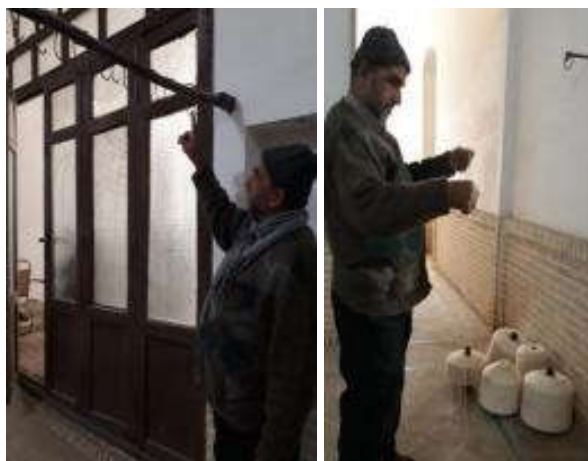
تصویر ۲۲ راست: تبدیل کردن چند رشته به یک رشته ضخیم‌تر. چپ: میله فلزی میانه تالار با چندین میخ فلزی شکل
