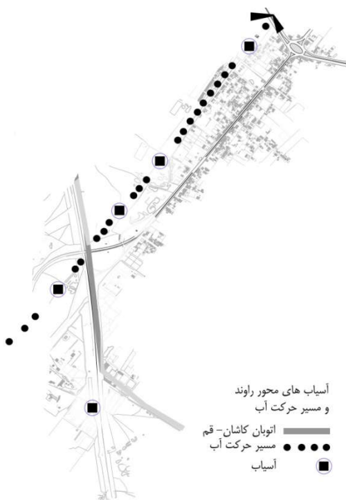
تصویر ۸: جانمایی آسیاب‌های راوند و مسیر حرکت آب (تهیه و ترسیم: نگارندگان)
