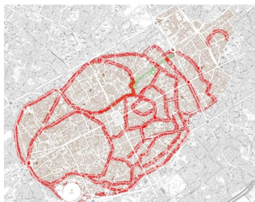
شکل ۱۵- الگوی رشد شهری کاشان به صورت حلقه‌های سکونی است که رشد کرده و به هم متصل شده‌اند. ساختار غالب معابر کاشان به این صورت است که یک مسیر پیرامون یک محدوده را دور می‌زند و داخل آن محدوده شبکه‌ای از معابر، دسترسی ورودی بناها را تأمین می‌کند (ویرایش روی نقشه جامع شهری کاشان توسط نگارندگان).
